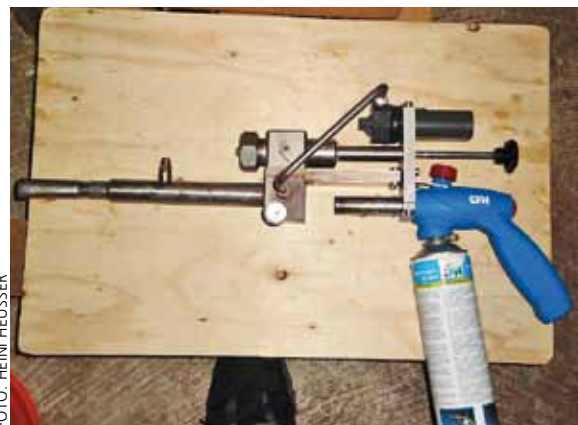
Oxalsäureverdampfer mit doppelwandigem, Wärmeöl gefülltem Verlängerungsrohr.
